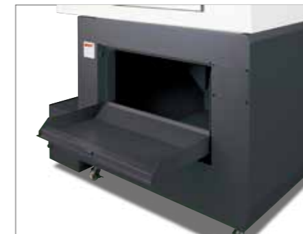
切粉存放箱 切粉的回收口, 开口设计较大, 便于清扫。
