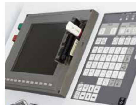
NC程序输入输出 使用USB存储器或者记忆卡, 可以输入输出NC程序。
