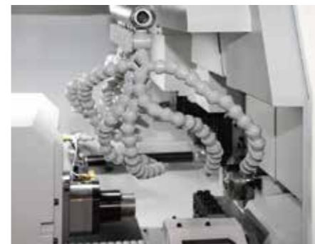
切削油喷嘴 结合加工状况, 可以从各个方向供给切削油。
