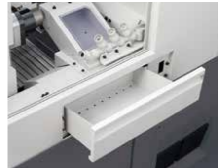
产品存放箱 将背面主轴夹持的工件排出到产品滑槽, 进行产品回收。
