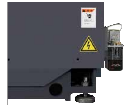
集中润滑装置 通过集中对全部的滚柱丝杠轴进行润滑, 无需手动加注润滑油脂。
